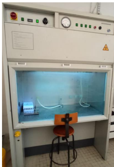
Figure 24: Stérilisation par UV dans une haute biologique
